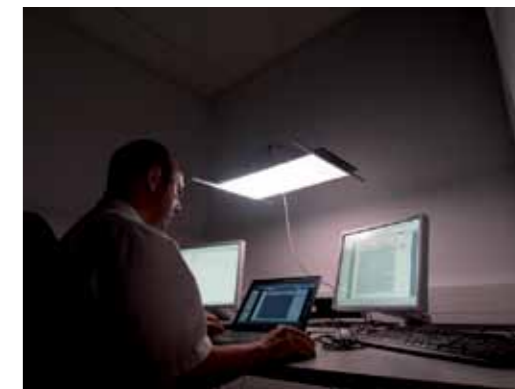
Das Stuttgarter Fraunhofer-Institut für Arbeitswissenschaft und Organisation (IAO) hat den Prototyp der aus 40 LED bestehenden „Heliosity“-Arbeitsplatzleuchte vorgestellt. Testpersonen der ersten Pilotstudie fanden das neue System deutlich angenehmer und belebender als herkömmliche Lichtquellen. (Foto: Fraunhofer IAO)
