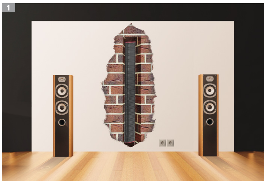
zu 1: Multimedia-Rohr in der Wand montiert
